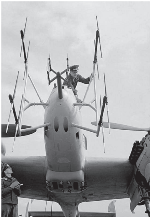
Messerschmidt Bf 110 in der Nachtjägerversion. Am Bug deutlich erkennbar das „Hirschgeweih“, die Antennenanlage des „Lichtenstein-Geräts“.
