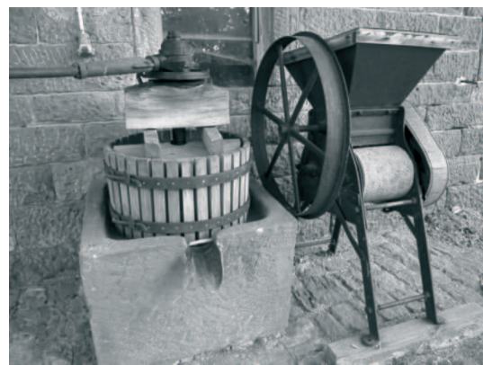
Bild 25: Presse auf Steinbiet, Spindel fast verdeckt. Obstmühle mit zwei Mahlsteinen, Antrieb über eine Transmission mit Elektromotor. Benutzt bis 2000.
