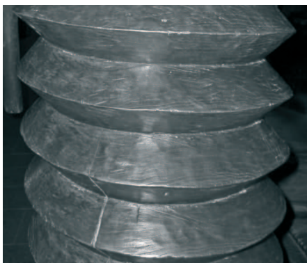
Bild 22: Gewinde der Holzspindel Durchm. 33 cm.
