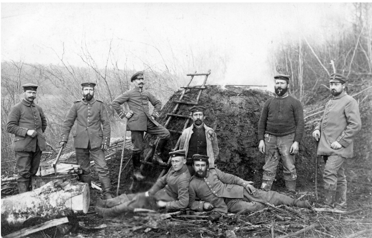
Das Holz wird mit Reisig bedeckt und später mit Erde, danach konnte der Meiler entzündet werden.
