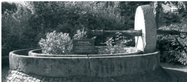
Bild 11: Quetschtrug in Tripsdrill, Durchmesser 4 m.
