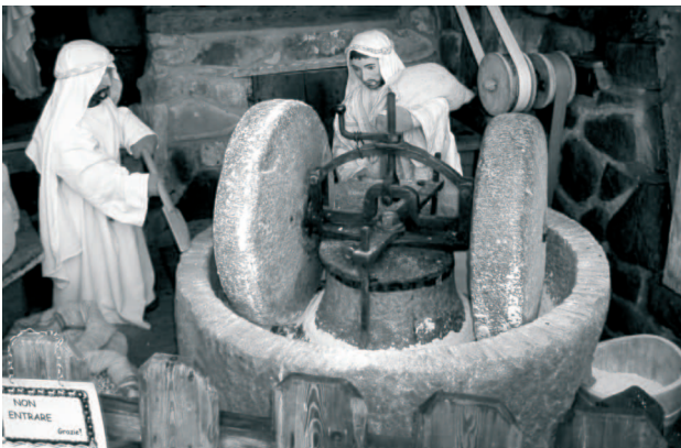
Bild 15: Kollergang mit Drehantrieb, aber von unten. Im Trog mit 120 cm Außendurchmesser liegt Maismehl. Bei großen Kollergängen fehlt die Insel in der Mitte und der Antrieb erfolgt durch eine senkrechte Achse von oben. Miniatur-Freilichtmuseum Valesa/Trentino/Italien 2009.
