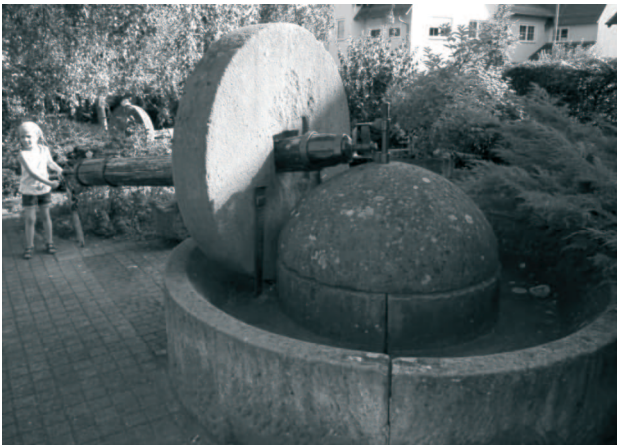
Bild 12: Sehr enge Quetsche für ein Zugtier in Tripsdrill.
