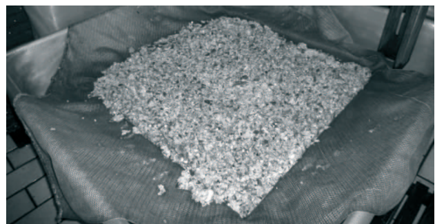
Bild 28: Maische im Presstuch mit Filterwirkung.
