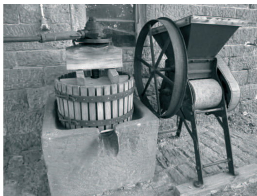
Bild 25: Presse auf Steinbret, Spindel fast verdeckt. Obstmühle mit zwei Mahlsteinen, Antrieb über eine Transmission mit Elektromotor. Benutzt bis 2000.
