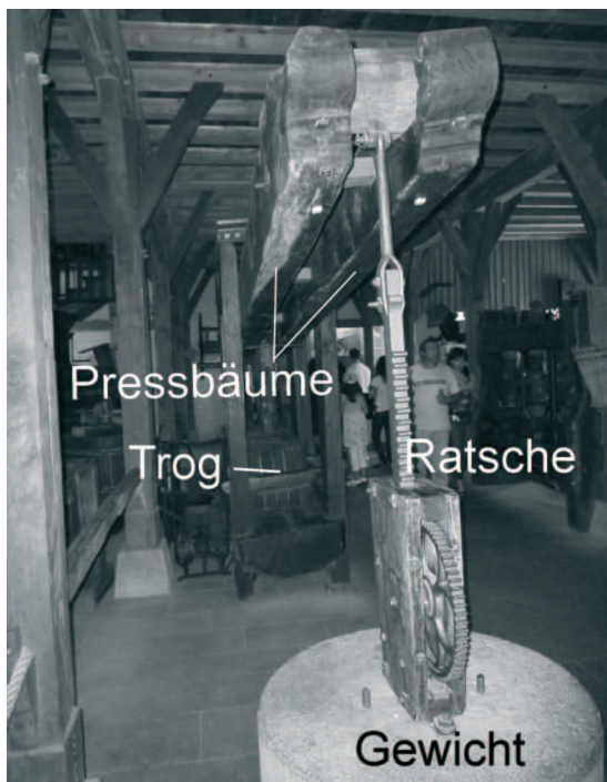
Bild 23: Winde (statt Holzspindel) mit Zahnstange zum Herunterziehen des Pressbaums, bis der unten stehende Gewichtstein aus einer Vertiefung angehoben wurde und frei schwebte. Erbaut 1860, Tripsdrill 2009.
