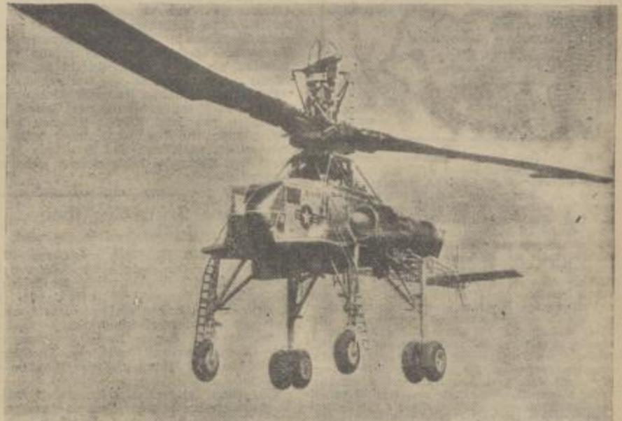
Der größte Hubschrauber der Welt, der XH-17-Helikopter der US-Air-Force, macht gegenwärtig seine ersten Probeflüge in Kalifornien. Der Riese, der schwere Geschütze und Fahrzeuge zum Einsatz transportieren soll, ist über neun Meter hoch, seine Luftschraube hat eine Spannweite von fast 40 Meter. Foto Keystone
