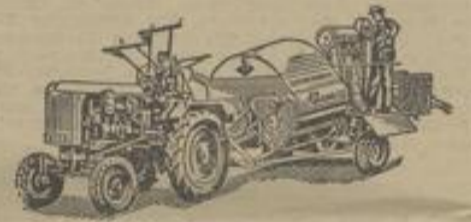
Class-Mähdrösch hat bei 5 Fuß Schnittbreite eine Körnerleistung von etwa 30 Ztr. je Stunde. Zum Antrieb genügt ein 25-PS-Schlepper mit Zapfwelle.
