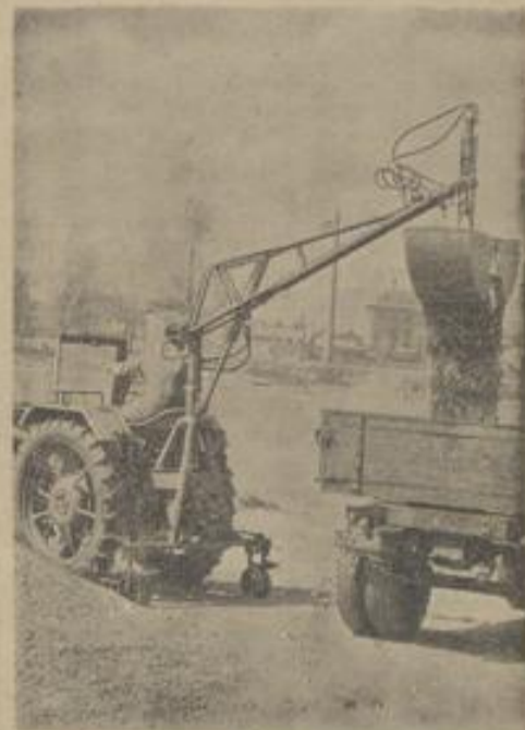
In Verbindung mit dem Atlas-Lader läßt der Bulldog nicht nur lose Güter wie Kohlen, Kies, Erde und Steine, sondern ebenso zuverlässig auch Kisten, Fässer, Säcke, ja selbst Stämme und Geleise.
