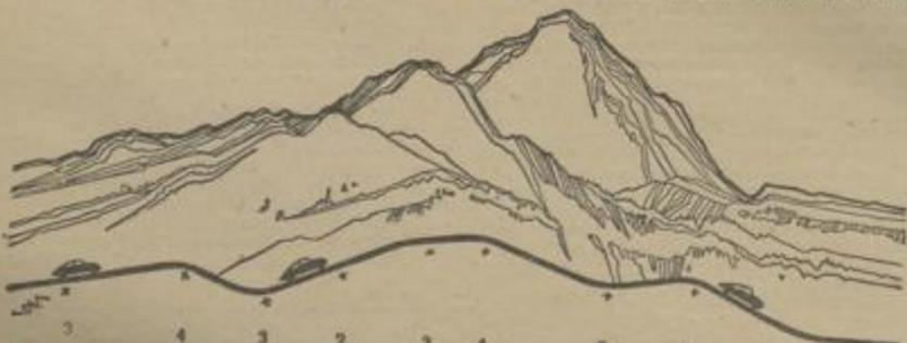
Rechtszeitiges Schalten am Berg hält den Motor auf Touren und den Wagen in Fahrt. Wir haben in dieser schematischen Darstellung jene Punkte, an denen wir schalten müssen, mit einem Kreuz gekennzeichnet.
