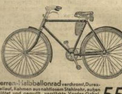
**Herren-Halbballonrad** verchromt, Durex-Freilauf, Rahmen aus nahtlosem Stahlrohr, außen gelötet und gemuldet, verstärkte Vorder-Gabel, Radial-Ringlager, Elastiksattel, NSU-Lenker ermöglicht breite und bequeme Armhaltung, mit Pumpe, Werkzeugtasche mit Inhalt, 1 Jahr Garantie **55.-**
