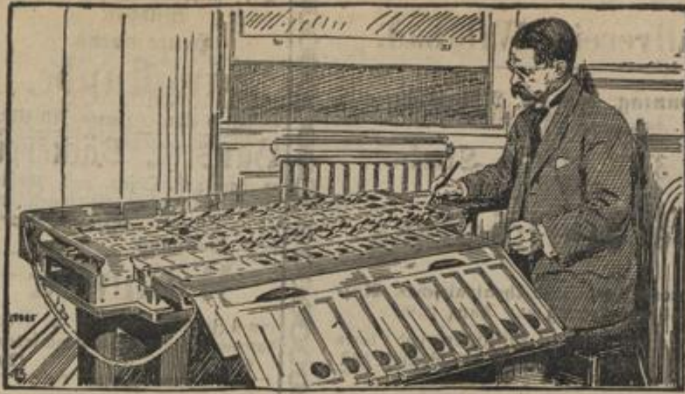
Um das zeitraubende handschriftliche Unterzeichnen von Aktien, wie es das Wesen vorschreibt, zu vereinfachen, verwendet eine amerikanische Aktiengesellschaft einen Apparat, bei dem 18 Füllfedern gleichzeitig den Namenszug des unterschreibenden Direktors wiederholen.
