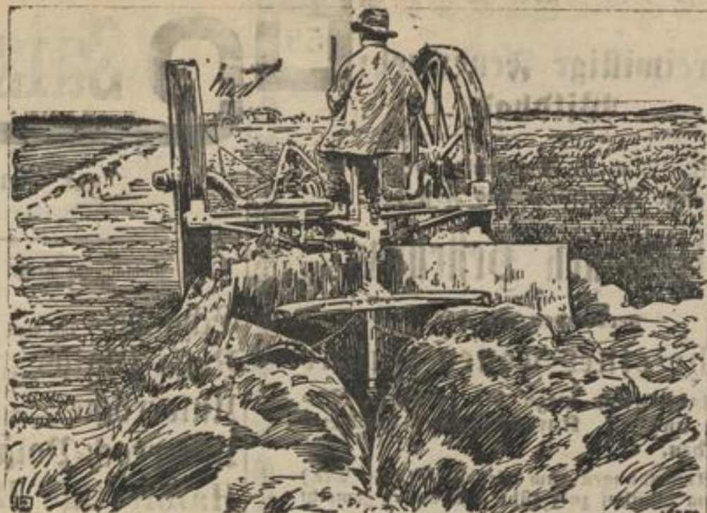
Ein Automobilpflug zum Aufwerfen von Schlinggräben. Dieser von einer englischen Firma konstruierte Automobilpflug kann im Kriegsfall von großen Nutzen sein, es lassen sich mit dem Pfluge mit größter Schnelligkeit Schlinggräben aufwerfen und die Konnschollen werden dadurch von einer schwierigen Arbeit entlastet.
