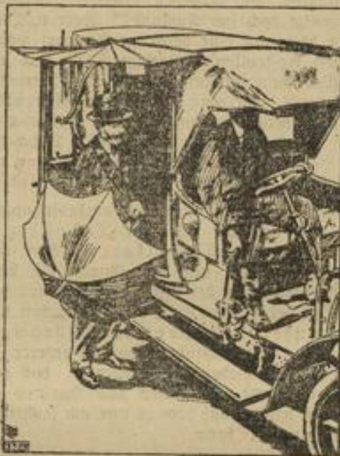
Ein System für Automobilmaschinen. Diese Erfindung eines französischen Ingenieurs ermöglicht, bei Regenwetter das Fahrzeug während des Ganges zu steuern. Eine am Lenkhebel des Lenkers angebrachte schirmartige Vorrichtung schützt die selbsttätig beim Öffnen des Lenkers und Lenkers Schließen wieder zusammen.
