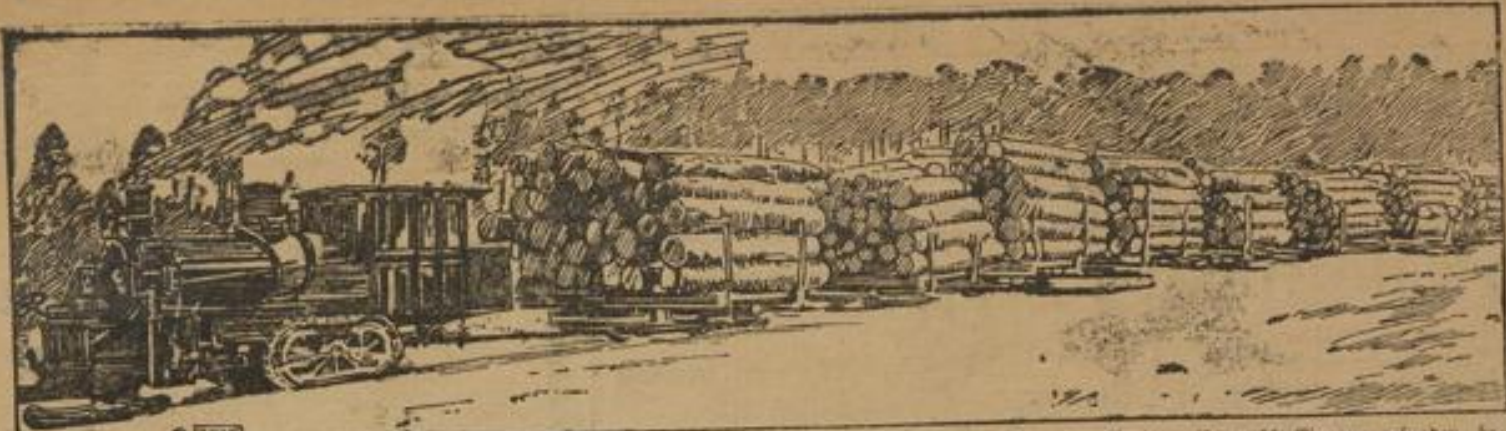
Schlittenlokomotive und Schlittenzug. Dieses neue Transportmittel hat in den Holz- und sämmerreichen Gegenden Nordamerikas rasch Eingang gefunden, besonders zur Beförderung der gefällten Baumstämme aus dem Wald zur Sägemühle. Die Lokomotive ist nicht nur im tiefsten Schnee verkehrsfähig, sondern auch auf dem Eise, wobei nur ein mit scharfen Röhren versehenes Antriebsrad einzuwirken ist, das in das Eis eingreift und so das Gleiten verhindert.
