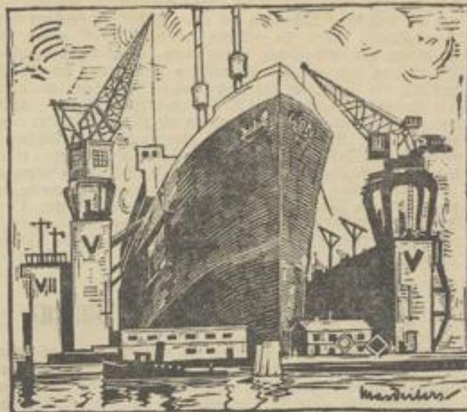
Ein „Ballin“-Dampfer der Sapan im Dock der Werft von Blohm & Voß Einstufige oder Dampfer der „Ballin“-Klasse erhalten durch Erben neuer Maschinen, Räder, Wellen und Schwaben eine höhere Leistungsfähigkeit
