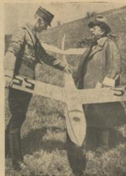
Segelflugmodell mit Photozelle zur Selbststeuerung
