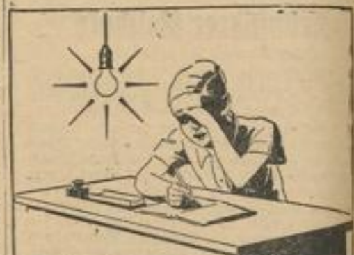
Die unabgeschirmte Glühlampe blendet, harte Schatten treten auf. Die Augen werden überreizt, ihre Sehfähigkeit wird herabgesetzt.
