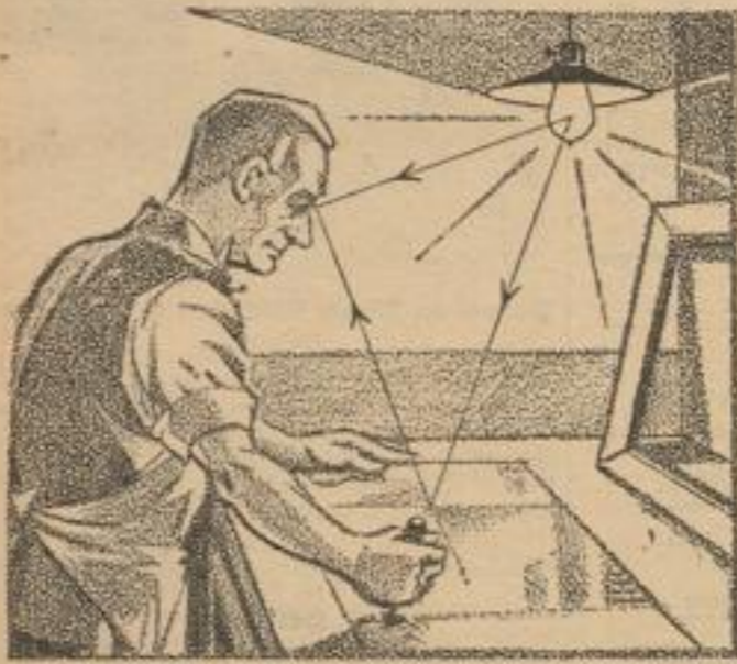
Blendung des Arbeitenden durch die ungenügend abgeschirmte Glühlampe und durch ihr Spiegelbild auf glänzender Arbeitsfläche.
