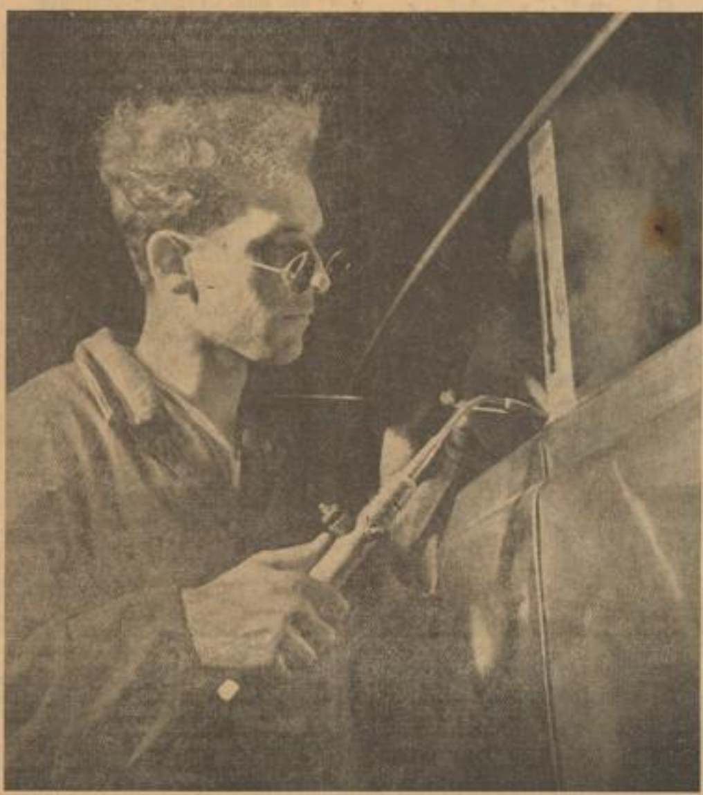
Zum Schluß die Feinarbeit. Die kleinen Unebenheiten einer im „Rohbau“ fertigen Karosserie werden mit Lötzin ausgeglichen. Aus dem Buch „Am laufenden Band“, Verlag Gustav Fischer, W.
