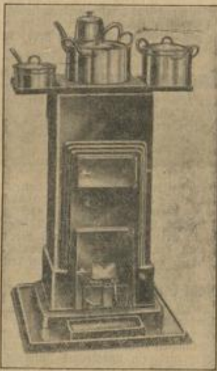
Beim modernen eisernen Ofen bietet der aufklappbare Deckel eine ständige Kochgelegenheit. Die durch einen langen Weg geführten Heizgase ermöglichen eine besonders gute Ausnutzung der Wärmekraft.
