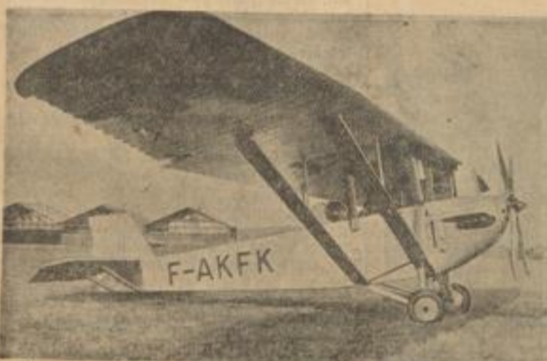
Neue Versuche mit Stratosphärenflugzeugen in Frankreich. In Frankreich werden zur Zeit Versuche mit diesen Stratosphärenflugzeugen durchgeführt. Der vierteilige Propeller ist variabel und wird von einem 500 PS-Motor angetrieben. Ueber dem Pilotensitz befindet sich eine Glocke, durch die der Sitz luftdicht abgeschlossen werden kann (siehe Bild rechts). (Wolff-Bild-Zentrale, R.)
