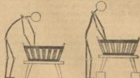
Zu niedrig stehendes Waschgefäß erzwingt gebückte Haltung, Anstrengende Arbeit.
