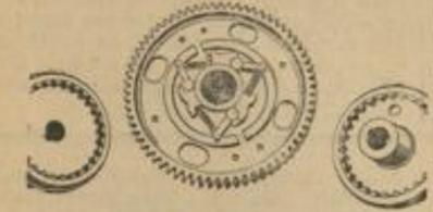
Krupp-Kugellager-Rollenhub-Grasmäher. Einzelteile des Fortschrittsgetriebes. In der Mitte das linksverkehrt wirkende Zahnrad aus verchromtem Zementstein mit den Strahlrinnen und Kugellagern; rechts und links daneben die Kugellagergehäuse, ebenfalls aus Zementstein, mit hoher Rollenbahn.
