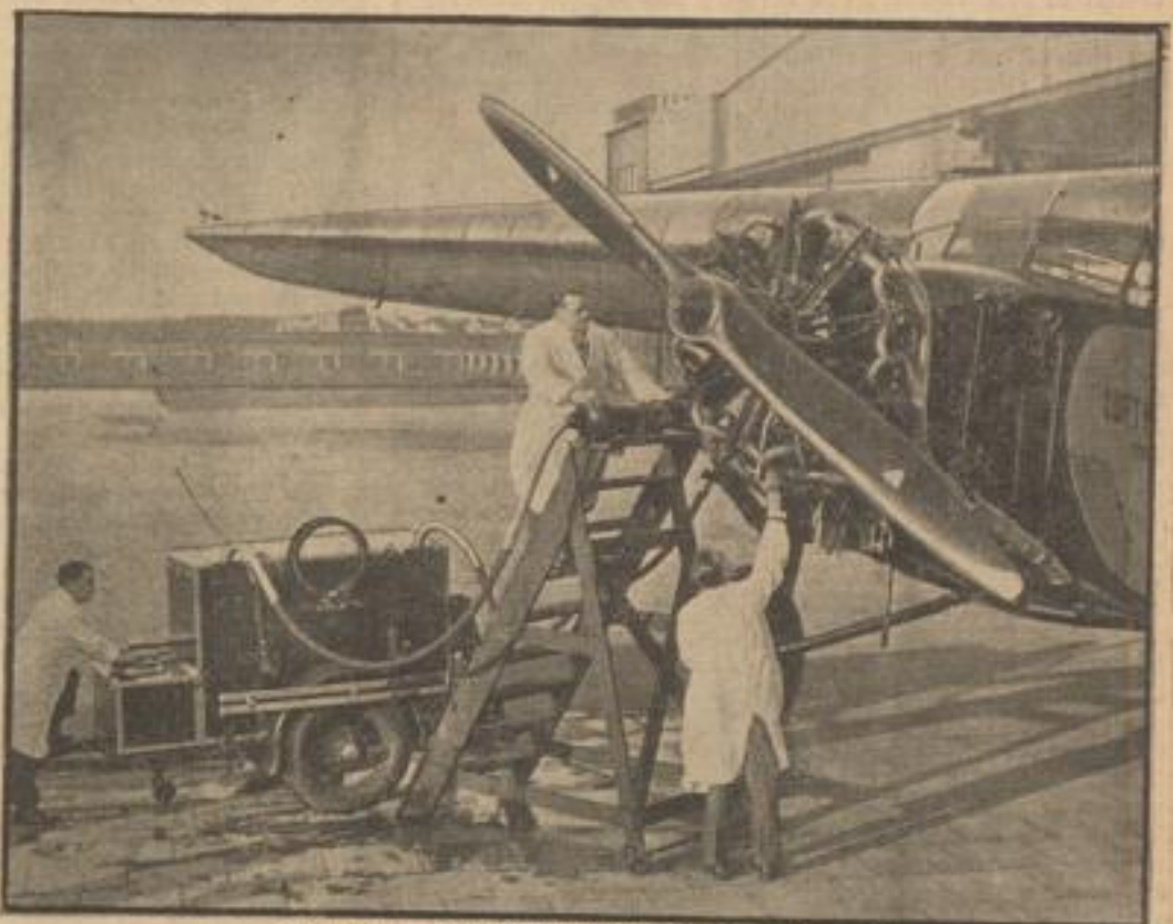
Flugzeuge werden durch Röntgenstrahlen überwacht. Die Deutsche Luft Hansa hat eine fahrbare Röntgenapparatur eingerichtet, mit der in gewissen Zeitabständen Motore, Propeller und Tragflächen durchleuchtet werden, um so geheime, sonst unsichtbare Materialfehler zeitig festzustellen.
