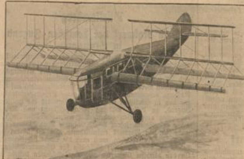
Eine Umwälzung im Flugweier stellt diese Neukonstruktion dar, deren Bau jetzt in der Berliner Werk der Rohrbach-Werke begonnen wurde. Das Flugzeug wird nur durch rotierende Flügel angetrieben und soll senkrecht starten und landen können.
