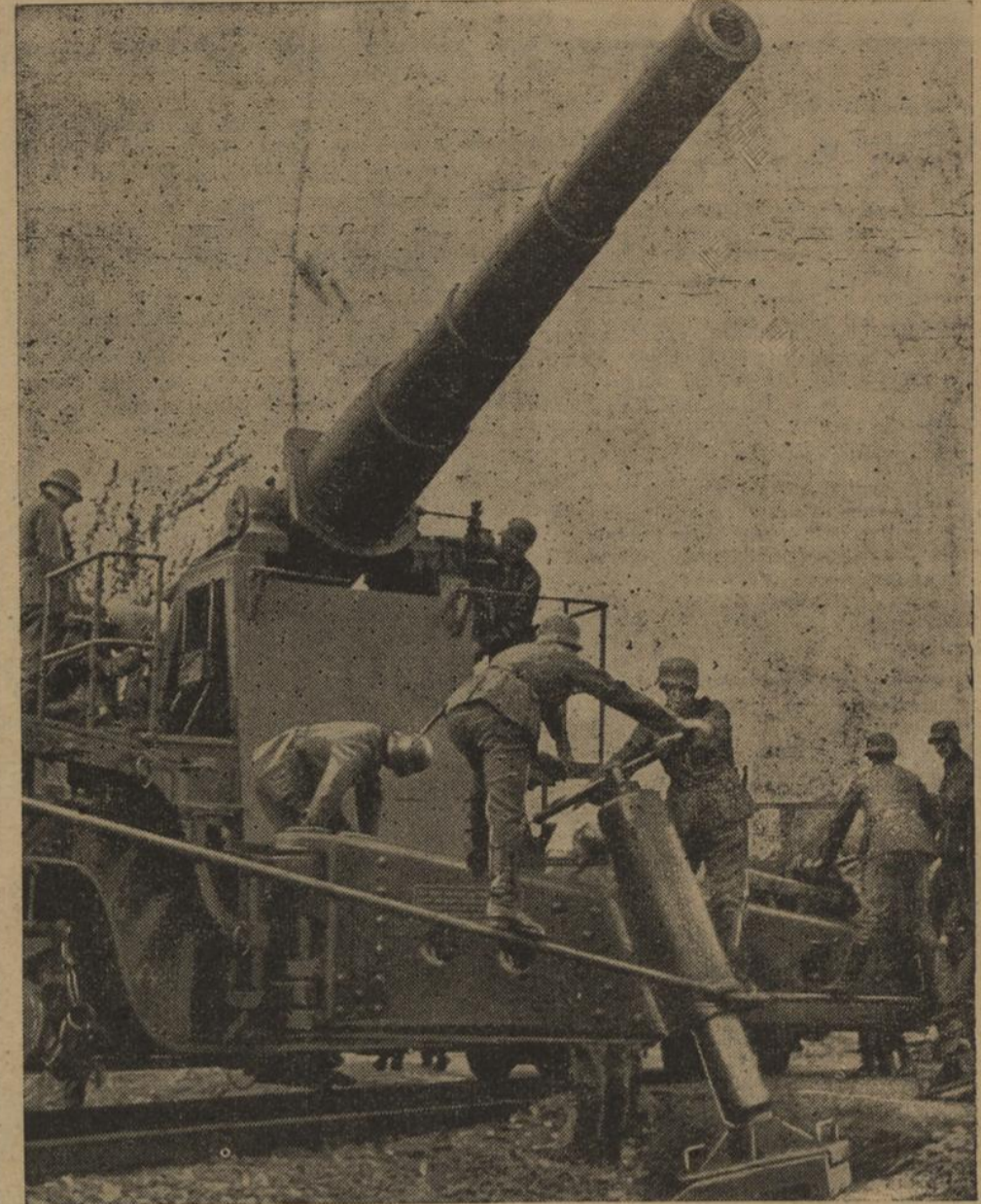
Die schwerste Artillerie unserer Wehrmacht übt. Ein schweres Eisenbahngeschütz, das vor dem Schuß durch Ausleger abgestützt wird.
