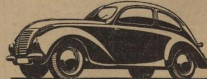
Das neue stromlinienförmige Personenwagenmodell von Hanomag besitzt eine selbsttragende Ganzstahlkarosserie
