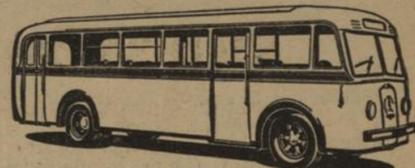
Mercedes-Benz Pullman-Omnibus Typ OP 3750 mit 100 PS, Sechszylinder-Dieselmotor
