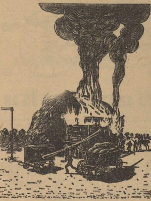
Heißlaufen der Rager bei der Dreschmaschine. Pflegt und beobachtet die Maschinen! Ost schon ist aus dem Heißlaufen der Dreschmaschinenlager ein gewaltiger Erntebrand entstanden. Zeichnung: H. S. Profferschwab (Rumberg).
