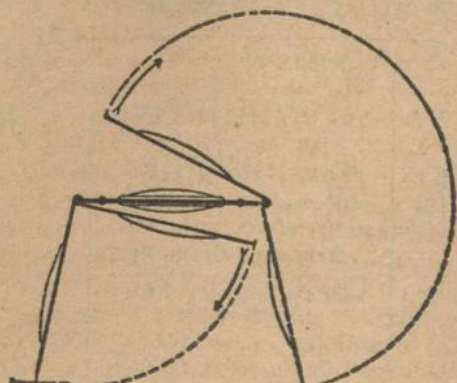
Zum Aufstellen linken Steg im 1/4 Bogen nach unten und rechten Steg im 1/2 Bogen herumklappen
