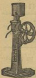
Eine Erfindung auf dem Gebiete der Milch- und Landwirtschaft hat der Fortschritt gebracht, indem jetzt eine Centrifuge mit Selbstentleerung und Selbstreinigung angefertigt wird, ohne Schnüre, ohne Einsätze, ohne Zeller, ohne Dichtungsringe, die nicht geöffnet und nicht geschlossen werden braucht.
